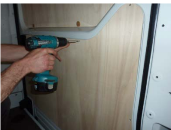
Placez & vissez la partie basse de La porte latérale 10 vis 4x30
