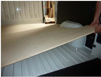
Placez & vissez les trois parties du Plancher 26 vis 4x25
