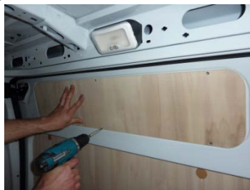
Placez & vissez la partie haute de la Porte latérale 6 vis 4x30
