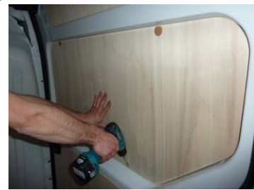
Placez & vissez la partie centrale de La porte latérale 4 vis 4x30
